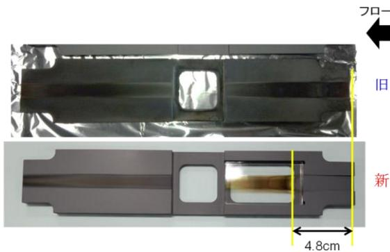
図3 グラファイト部材(上)及び石英部材(下)を用いた時の成長後のフローチャネルの汚れの違い
