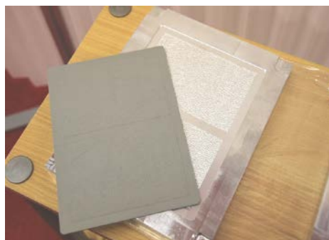
図4 合成されたシボデータによる金型加工
