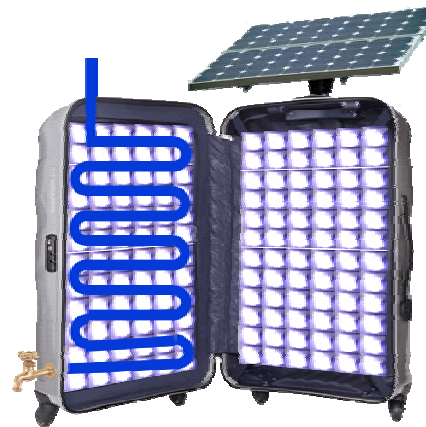
図6 . ワイドMIPEを用いたポータブルタイプ水浄化システムの例。
