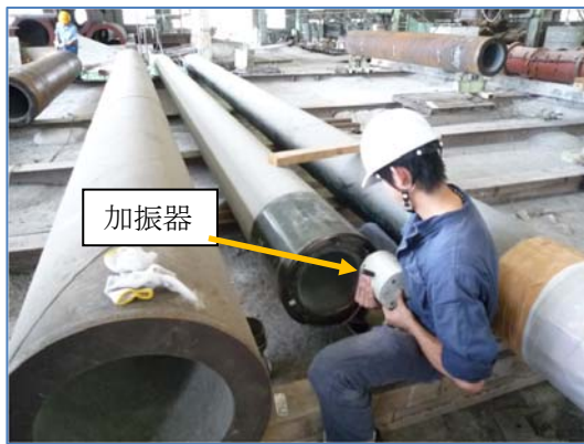
写真-1 既製杭の振動計測（気中）
