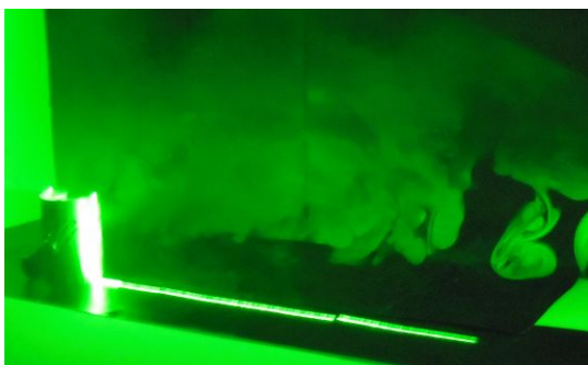
図8 エアースンプラー周辺の気流可視化実験
