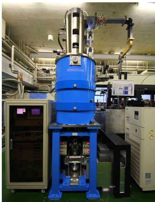
図 1 フェムト秒時間分解 MeV 電子顕微鏡実証機の写真
