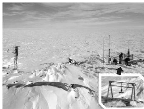
図10 南極 Larsen 氷河の観測施設 (イタリア) に設置された吹雪観測システム
