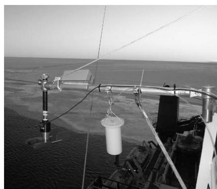
図11 砕氷船 (Polarstern 号) に設置された吹雪計測システム (左端)
