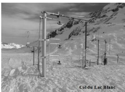
図7 フランスアルプスの Lac Blanc 峠に設置された吹雪観測システム (ABS と SPC) による比較観測
