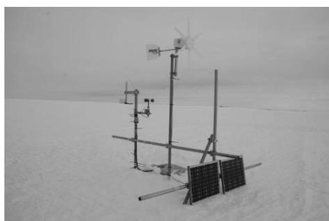
図8 南極氷床上 (S16 近傍) に設置された吹雪観測システム
