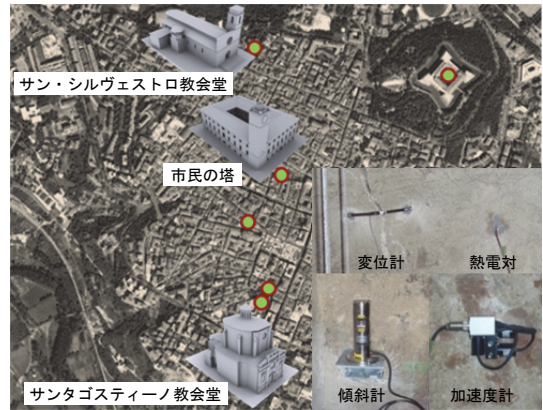
図6 ラクイラのモニタリング対象建物とセンサー
