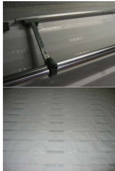
図3 UHF 帯 RFID テキスタイルの織機織 (上) と試作したテキスタイル (下)
