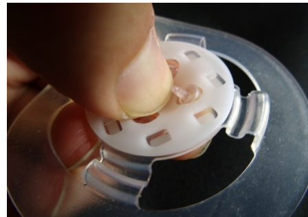
図3-2 パッシブ型触覚情報提示装置の試作例（アクティブ型デバイスでは表現できない、クリック感や凹凸感、突起の当たる感触などを表現する）
