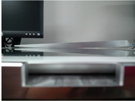
図 3-4 タッチパネル面に指に押圧力を加えた時に微小に上下動する面の変位量を検出する機構
