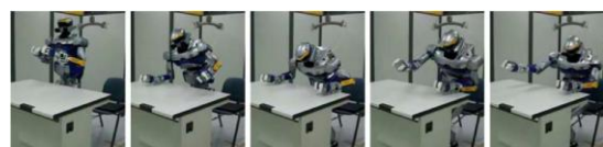
図 3 ヒューマノイドによるダイナミックな多点接触動作の例
