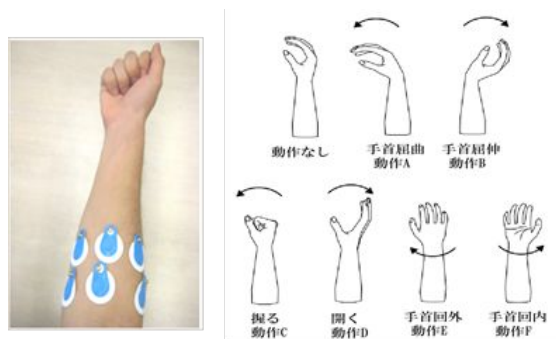
図4 筋電センサ電極(左)と推定した動作(右)
