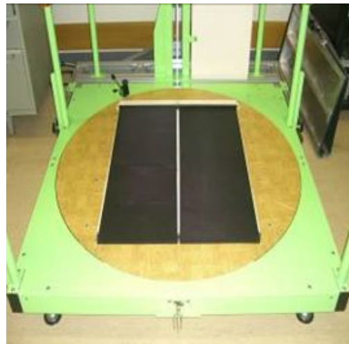
図5：立位部分(回転盤部分) (トレッドミル本体は、360度回転が可能で 訓練させたい方向に自由に設定可能である)
