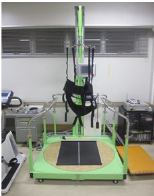
図4：今回の開発機器の全景 (100kgまで吊り上げ機能を有する)
