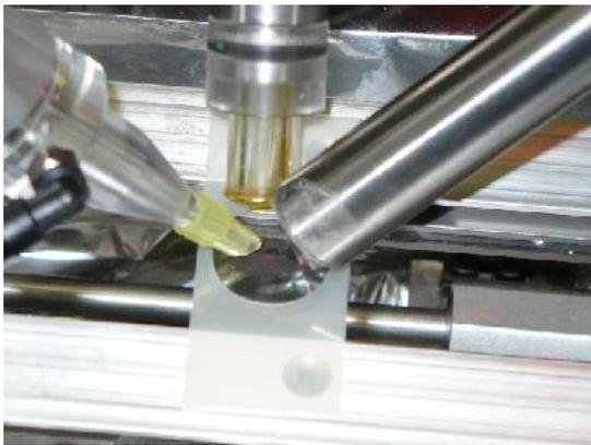
図 2. 大気二検出器同時分析システムの先端部。左が「先端キャップ」を装着した軽元素測定用、右が吸収体を装着した重元素測定用の Si(Li)、中央がビームの出口である。
