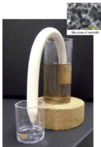
図6 動力を用いない浄水システム
