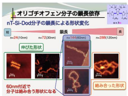
図-1 2 : エレクトロスプレー法でサンプル調製した大型分子鎖群の高分解能 STM 像
