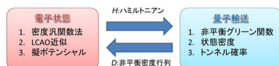
図1 第一原理電子状態・非平衡量子輸送シミュレーションの原理
