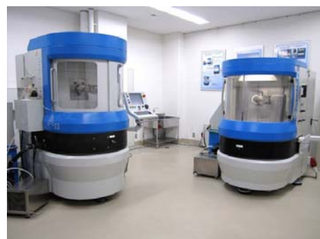
図4 非球面金型研磨に使用した7軸制御の研磨ロボットIRP200
