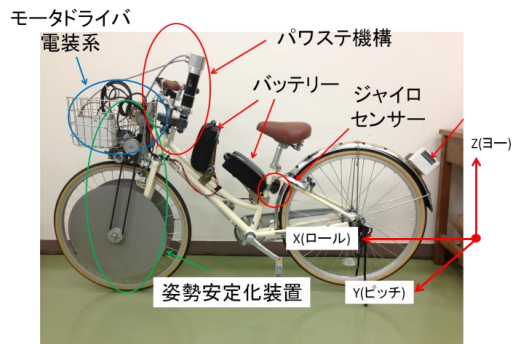
図4：開発したステアリングを補助する機械的姿勢安定化装置付自転車
