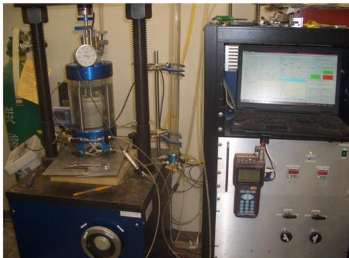
写真-1 三軸圧縮試験装置の外観
