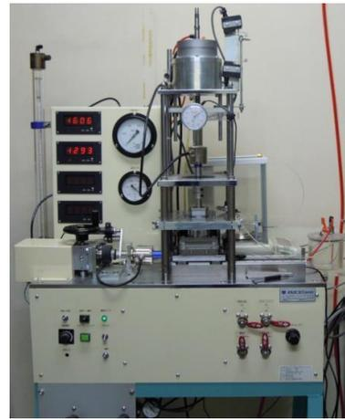
写真-1.1 低圧単純せん断試験機
