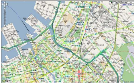
図 5 福岡市近郊部におけるタクシープローブデータによる各道路リンクの移動平均速度(2009年7月26日, 9時)
