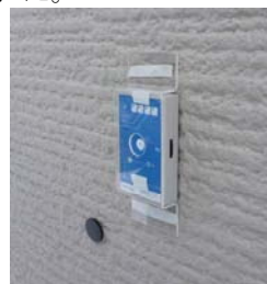
写真1 MEMS加速度センサの設置状況
