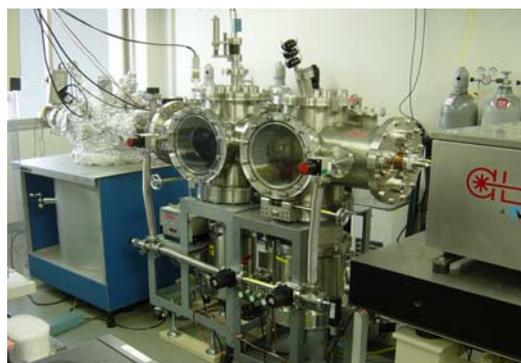
図1 実験に用いたレーザーデトネーションビーム装置
