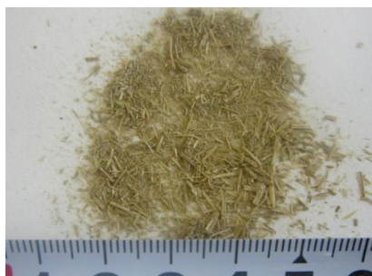
(a) ミキサーによる乾式粉碎
