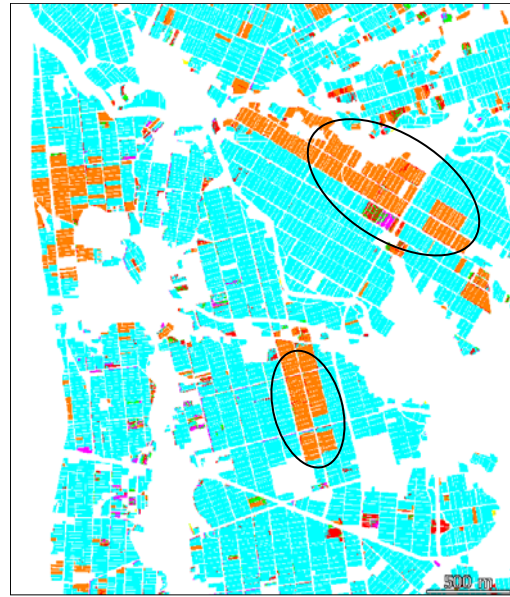
図9 Xバンド SAR \sigma^0 の圃場平均値とWorldView-2の光学4バンド値を用いた分類結果(K-means法)。○部分は本手法により抽出精度が特に向上したエリアを示す。
