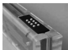
図2 点字触覚刺激装置 ピンの直径1.3 mm, ピン間隔3 mmの配列で、1 msecで刺激時間、刺激間隔を制御可能。
