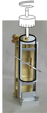
図 5 3次元局所 ESR 信号検出方式 ESR イメージング装置の試料台 (for 電磁ホーン):ホルダー (黒枠円柱) に小動物を入れ、電磁ホーン型 ESR の試料空間へ上から設置する。
