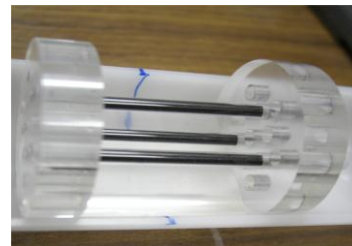
図 7 2、3本の DPPH 試料で構成されるファントム試料
