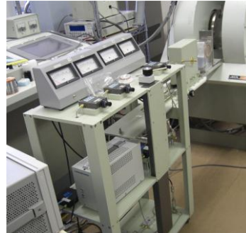
図 1 L-band 磁場/周波数掃引方式電磁ホーン型 ESR 回路 左下にアジレント製 YIG 周波数掃引/固定発振器を設置
