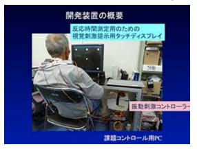
被験者は、タッチディスプレイの手がかり 刺激に応じて、課題を進める(写真下)。視覚 的な刺激が出現するタイミングに合わせて、 振動端子の振動刺激を発生させる時相を任 意に設定できる。また、4 つの振動端子は身 体の各部にテープで固定し、4 つのうちから 任意の部位の振動の発生を ON、OFF すること ができる。
