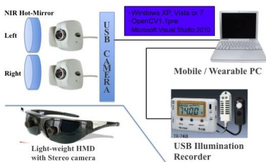
図3 開発したシステムの構成図
