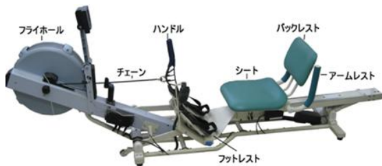
図 1 ローイングマシンの構成
