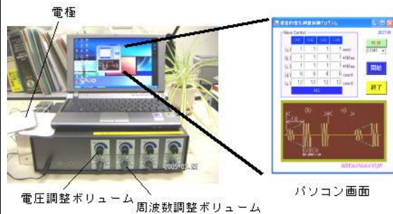
図8 表面電極 FES 刺激装置
