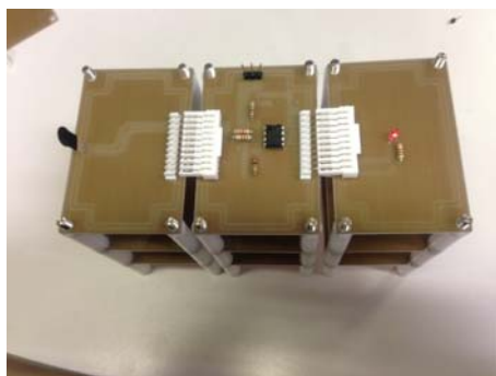
図5 改良した電子機能ブロックの接続例 (圧電素子-非反転増幅回路-LED)
