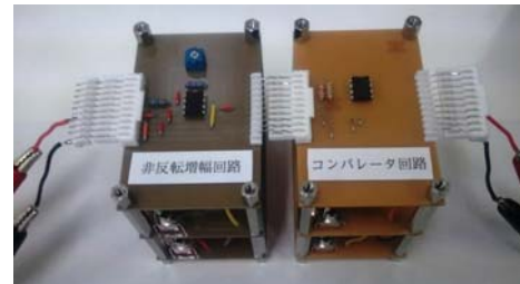
図2 非反転増幅回路とコンパレータ回路の接続
