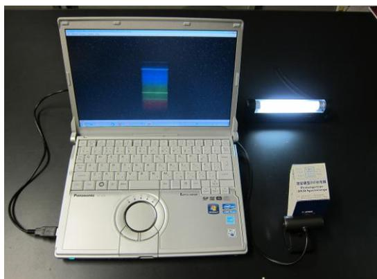
図3 DVD 分光器と WEB カメラを利用したスペクトル観察システム：潜望鏡型 DVD 分光器に WEB カメラを接続して (右)、観察している蛍光灯のスペクトルを画面上に表示している
