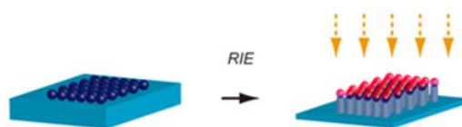
図 2 RIE と CL による微細構造形成
