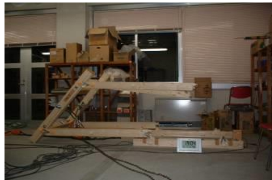
写真3 木造軸組の実験例、写真2の状態から傾きが進んで倒壊している状態
