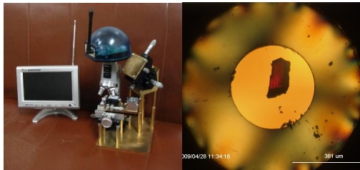
図 1: (左)ワイヤレス顕微鏡付マニピレータ 図 2: (右)DAC 内に封入された \text{KCuCl}_3 単結晶試料。圧力媒体はヘリウム・ガス
