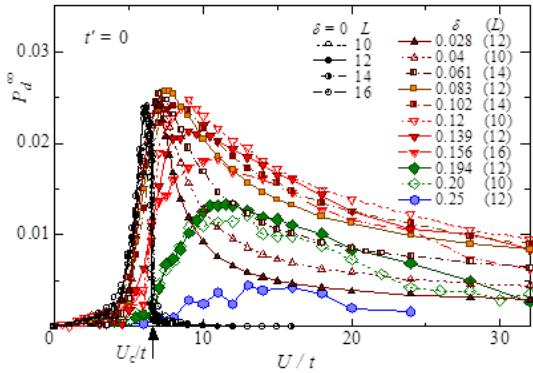
最適ドープ率周辺を頂点としたドーム型になっている。これは銅酸化物のTcや凝縮エネルギーの結果と一一致する。また、この領域で超流動密度 $P_s$ を計算すると $\delta$ に比例し、これは銅酸化物で得られている所謂植村プロットと一致する。一方、弱相関域( $U < U_c$ )では $P_s$ も $\delta$ も定量的のみならず、定性的に異なった振る舞いをする。従って、銅酸化物は従来のフェルミ液体やBCS超伝導の領域には存在しないことが判る。
