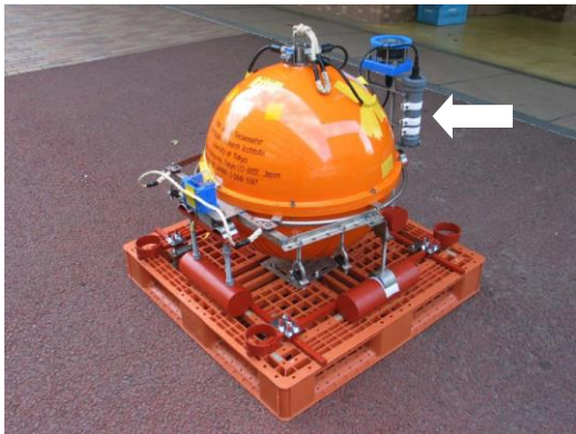
図2 広帯域海底地震計に装着した高精度水圧計(白矢印)
