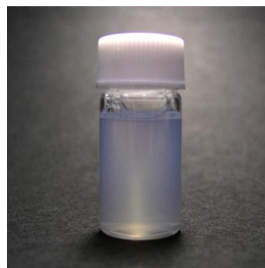
図6. 1 vol% のドデカンと超臨界水を 404°C、25 MPa で混合した後、室温にまで急冷した場合に生成したナノエマルジョン
