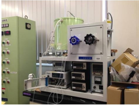
図2. 高温・高圧条件下でコロイド分散液を処理するために開発した実験装置
