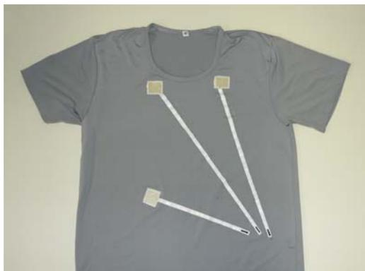
図2 試作した生体信号計測用 T-シャツ (印刷電極を使用) の一例 (T-シャツを裏返して撮影した写真)
