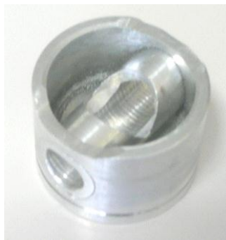
図10 圧接ピストンの試作外観(直径30mm)
