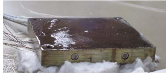
図 8 伝熱面の内部から液を染み出させて液供給する試験部
