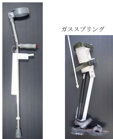
(a) 伸縮ロフトストランドクラッチ (b) 下肢関節駆動機
