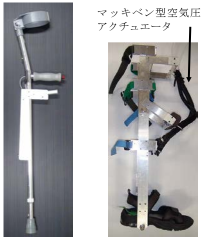
(a) 伸縮ロフトストランドクラッチ (b) 下肢関節駆動機
