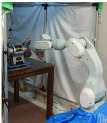
図2 面取り作業実験システム
