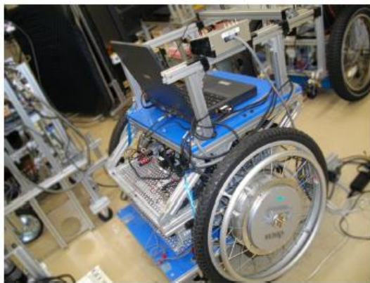
図1 キャスタレス2輪駆動電動車椅子
