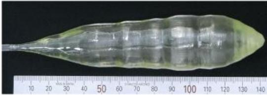
図 3 直径 1 インチの TSLAG 単結晶
