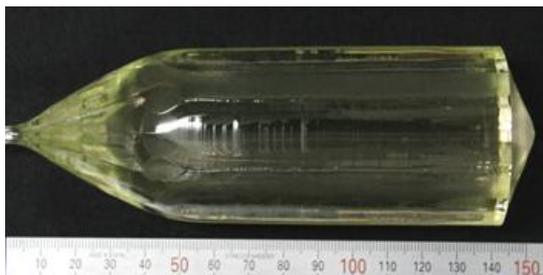
図 9 2 インチ大型・高品質 TSLAG 単結晶
