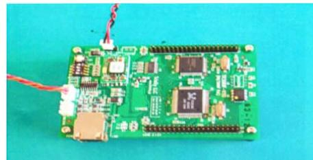
図7 H8/3069F マイコンボードの概観
