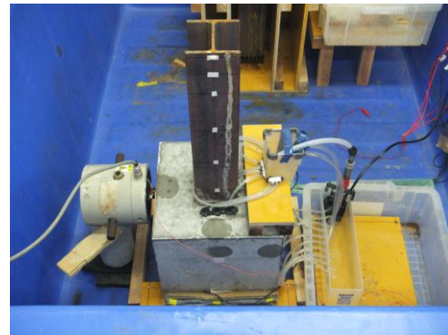
電食実験と非破壊試験
