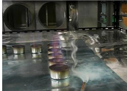
写真1 燃焼皿2cm間隔の場合の旋風再現
