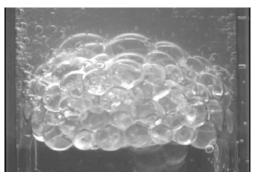
(b) 大流量・中粒径条件 図 5 界面への液泡の滞留
