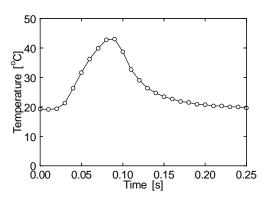
図7 液泡通過時の測定温度変化
