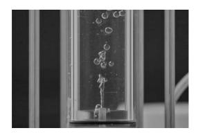
図 4 液柱先端の分裂による複数液泡形成
